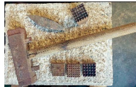
FIG. 35. *Buharda, diferentes cabezas de buharda y piqueta para labra de las caras de sillería*
