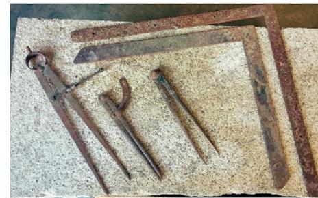
FIG. 34. *Escuadras y compases para la medición y el trazado*
